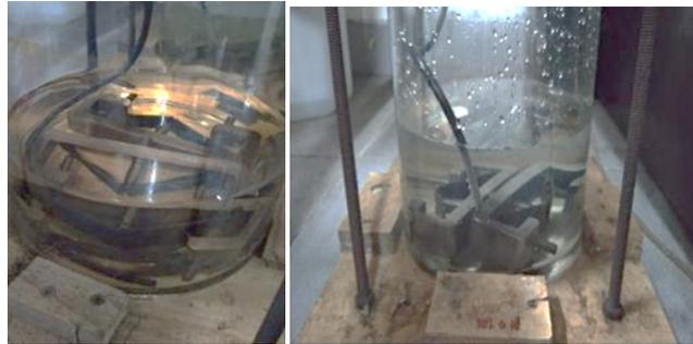
**Gambar 2** Proses uji korosi baja karbon API 5L X65 di dalam larutan (a) asam asetat, dan (b) air laut.
