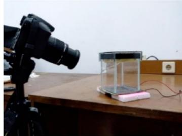
Gambar 4. Cloud chamber yang dibuat dan posisi kamera
