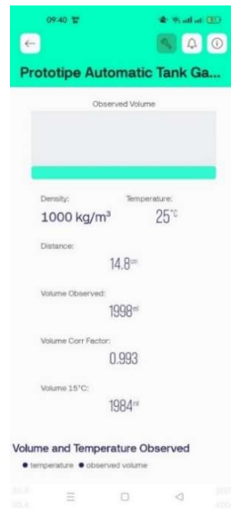
Gambar 5. Tampilan Hasil Pengukuran Prototipe Pada Aplikasi Mobile Blynk
