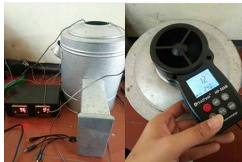
Gambar 2. Kompor Briket dan Anemometer dalam Pengujian Laju Pembakaran
