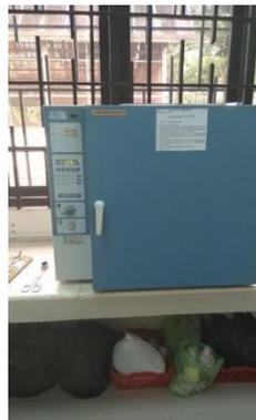
Gambar 3. Penghilangan kadar air menggunakan oven
