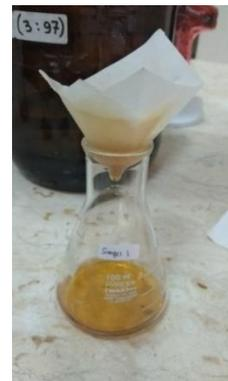
Gambar 2. Sampel filtrat untuk uji total asam
