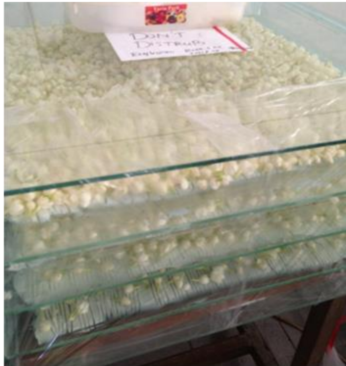
Gambar 3. Proses Ekstraksi dengan Menggunakan Chassis (50 x 50 cm 2 )
