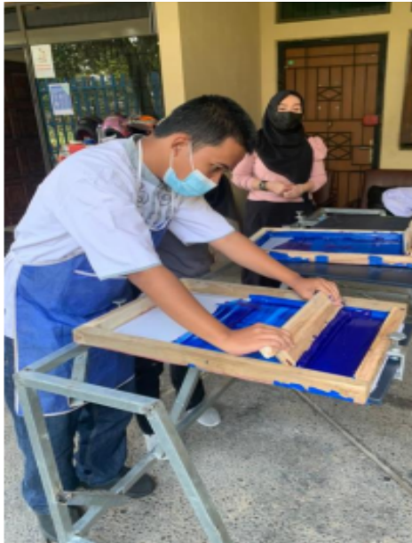
Gambar 3. Praktik dan Hasil Menyablon yang Dilakukan oleh Siswa (Sumber: Dokumentasi Pribadi, 2021)
