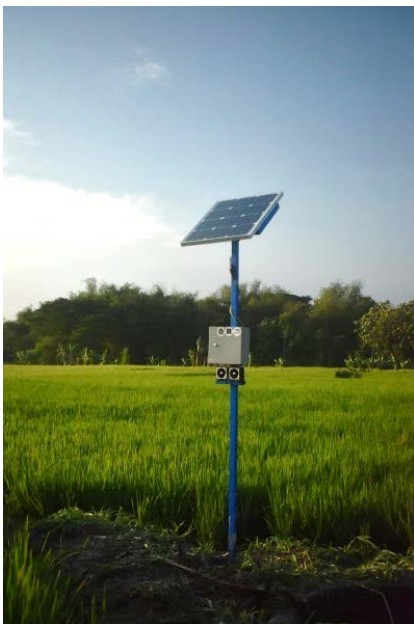
Gambar 3. Alat Pembasmi Tikus dengan Sumber Energi Matahari
