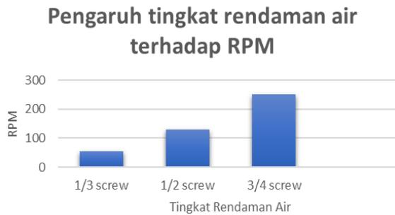
**Gambar 4. Hasil pengujian tingkat rendaman air terhadap rpm**
