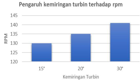
**Gambar 5. Hasil pengujian kemiringan turbin terhadap rpm**
