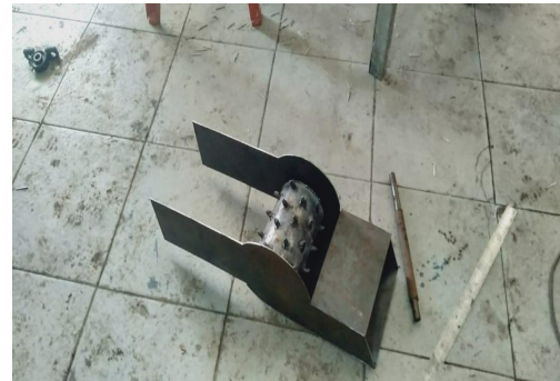
Gambar 4. Crushing Unit Disambungkan Pada Outlet
