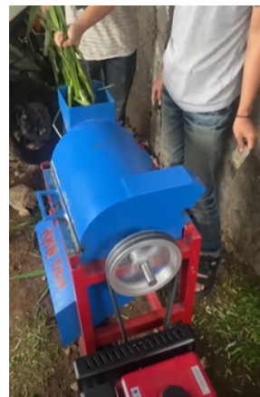
Gambar 6. Pengujian Mesin Pencacah Bahan Rumput
