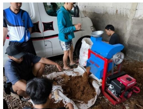
Gambar 4. Pengujian Mesin Pencacah Bahan Sabut Kelapa
