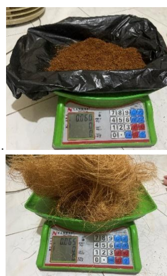
Gambar 5. Cocopeat dan Cocofiber yang Dihasilkan pada Rpm 1300
