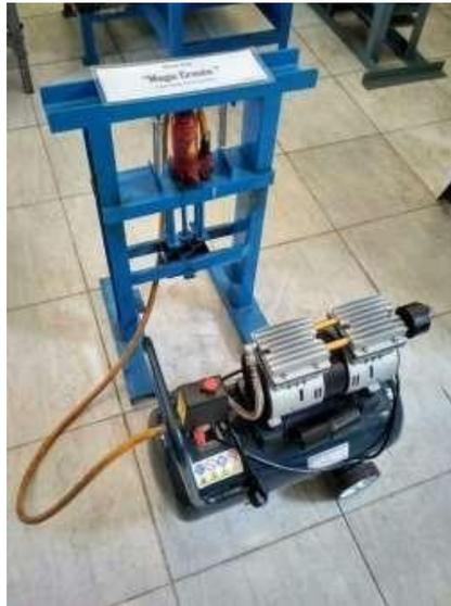
**Gambar 7. Mesin Pencetak Briket**
