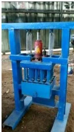
**Gambar 2. Mesin Pencetak Briket**
