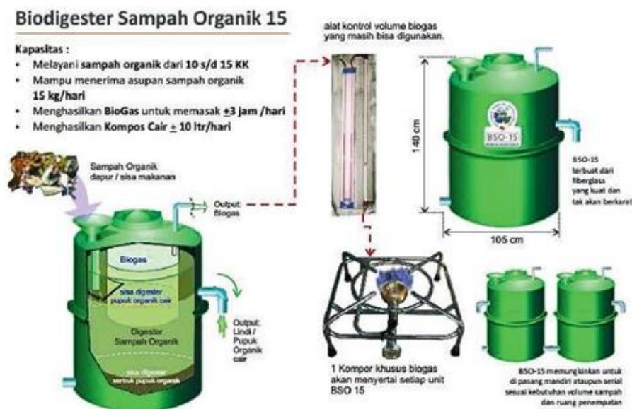
Gambar 1. Skema pengelolaan sampah dengan pemanfaatan teknologi Prototype biodigester
