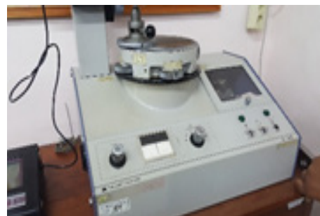
Gambar 1. A. Glass ionomer cement (GIC) dan resin modified glass ionomer cement (RMGIC) ; B. Cairan lambung buatan; C. Cetakan logam untuk pembuatan sampel; D. Alat uji kekasaran permukaan (Profilometri)
