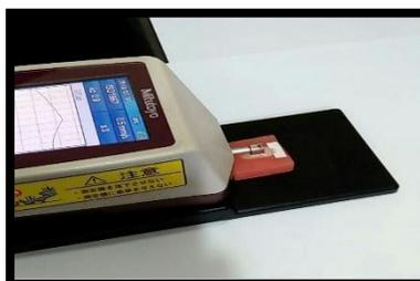
**Gambar 2.** Pengukuran sampel dengan alat profilometer (Sumber foto: Dokumentasi pribadi)
