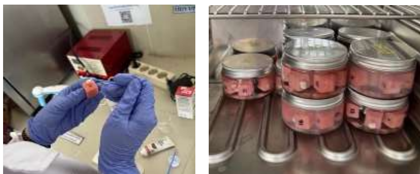
Gambar 4. (a) Pengolesan bahan remineralisasi (b) Penempatan sampel pada inkubator
