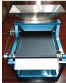
Gambar 3. Tampak atas alat pemisah pasir besi portable
