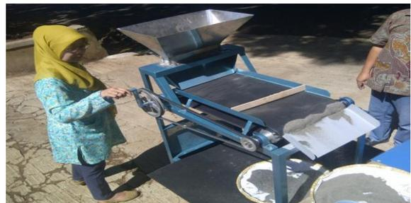
Gambar 4. Uji coba pengoperasian alat pemisah pasir besi portable
