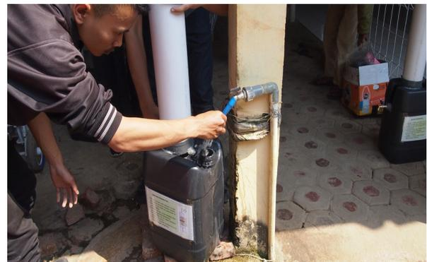
**Gambar 5. Alat filter air sederhana dengan komposisi batuan Zeolit, Pasir Silika dan Karbon Aktif yang di buat peserta KKN 2019 dalam kegiatan PPM terintegrasi**
