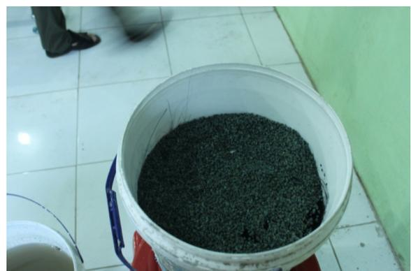
**Gambar 3. Pasir zeolit yang digunakan untuk mengurangi salinitas air payau**
