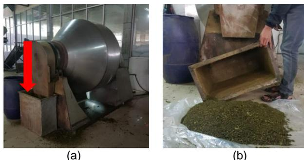
Gambar 1. Mesin Ball Tea dan cara pengambilan sampel: (a) tempat pengambilan sampel (tanda panah merah), dan (b) sampel dituang ke wadah plastik untuk ditimbang dan dilakukan proses analisis lebih lanjut.
