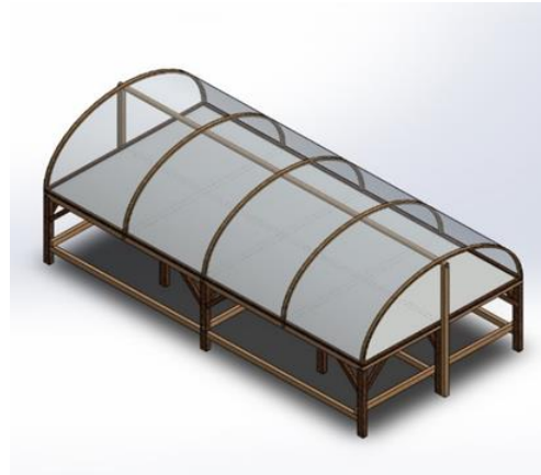
Gambar 3. Rancangan alat pengering tepung pati aren tipe ERK
