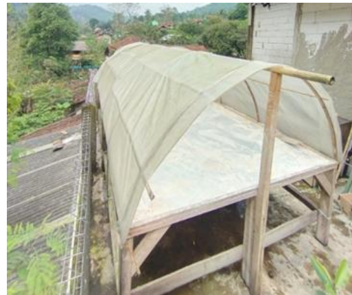
Gambar 4. Hasil rancang bangun alat pengering tepung pati aren tipe ERK
