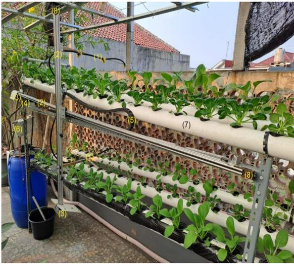
Gambar 3. Pemasangan manipulator robot pada rangka budidaya hidroponik: (1) Batang nosel atas dan bawah, (2) Rel *horizontal* dan *vertical*, (3) Motor *stepper* atas dan bawah, (4) Pompa *sprayer*, (5) Rantai pemegang pipa penyalur pestisida, (6) Kotak rangkaian pengendali, (7) Pipa hidroponik, (8) Pengencang *timing belt*
